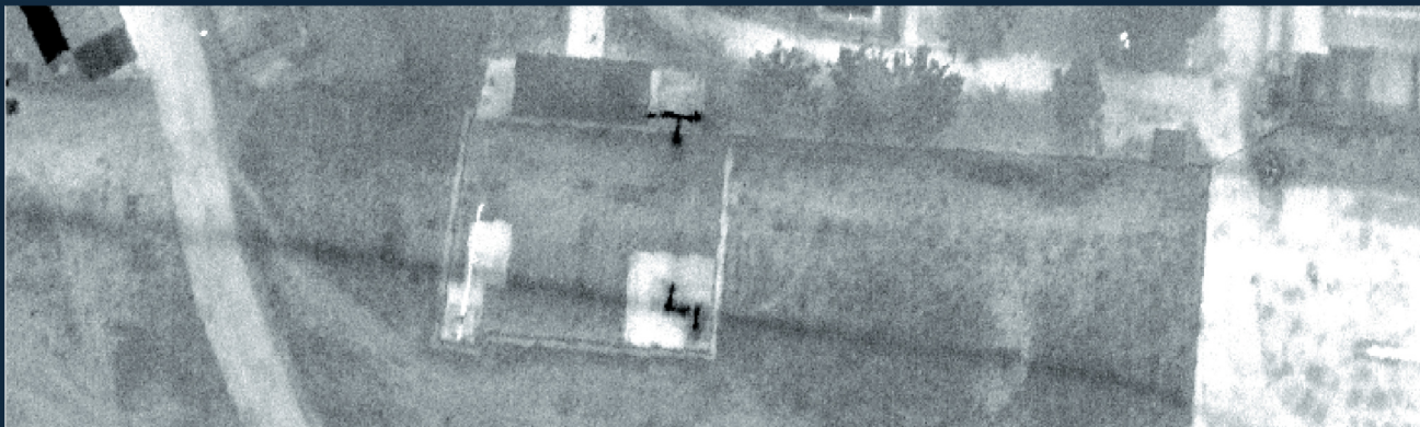
Подземный продуктопровод с аммиаком. Контраст с фоном при выходе на поверхность - 5°C. Контраст над заглубленной трубой — 0,5°C.
